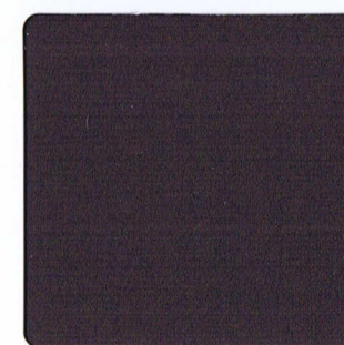
RN023 Sコゲチャ 日射反射率：46%
